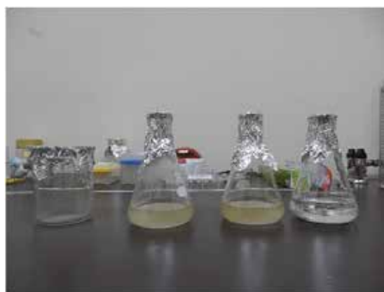
図2. 作成した実験試薬 左から、滅菌前のビーカー、滅菌前の蒸 留水と寒天粉末の混合物（2つ）、滅菌 前の蒸留水
